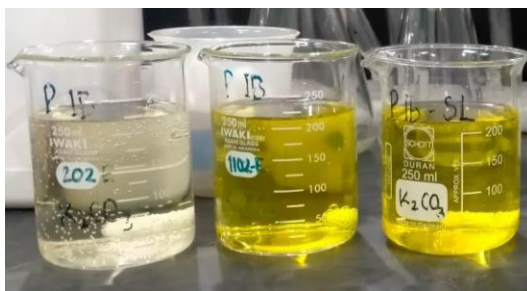
Gambar 1 Hasil titrasi akhir kalium karbonat ( K_2CO_3 ) pada larutan benfield menggunakan Autotitrator
